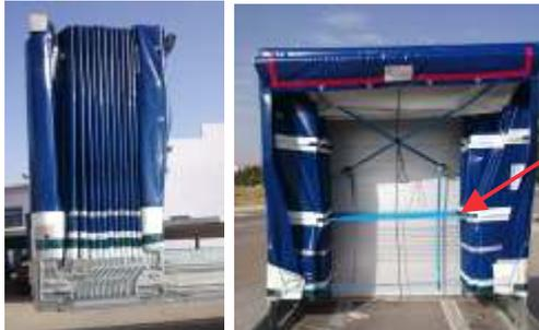
3ª ) Iniciar desde la parte delantera hacia la trasera la colocación de los pulpos "gomas" sobre la cinta negra que aparece entre los arquillos para meter los pliegues del toldo hacia el interior
